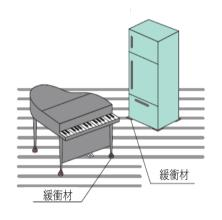
●フリーフロアーを施工前に重量物を設置する場所が決まっている場合 フリーフロアーを施工前にピアノや本棚などの重量物を置く場所や重さ、寸法 が分かっている場合であれば、下記の①と②を行うようにしてください。
