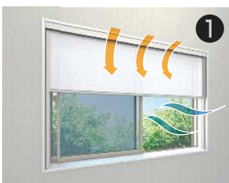
●スクリーン半閉じ (遮光+通風あり)
