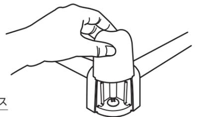
※コンクリート壁下地の場合は、下地面に予めM6用コンクリートプラグを取り付けてください。
