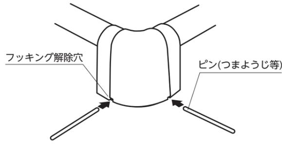
コーナーキャップのフックが解除されたら手でコーナーキャップを外します。
