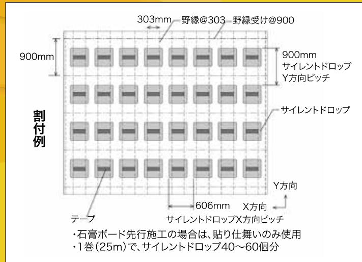
※サイレントドロップの配置ピッチは、野縁と直交方向(X方向)は606mm、野縁と平行方向(Y方向)は900mmとして1m<sup>2</sup>当たり1.5～2個となるよう配して下さい。
