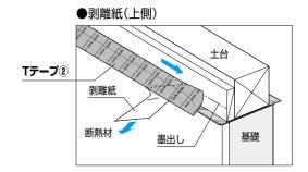
\_\_\_\_\_\_\_\_\_\_ Tテープ②の胴縁側面への直接貼り付け寸法は20mm以上 としてください。
