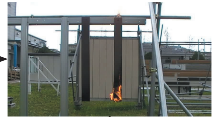
ガスバーナー除去後12秒でプラスッド鎮火
