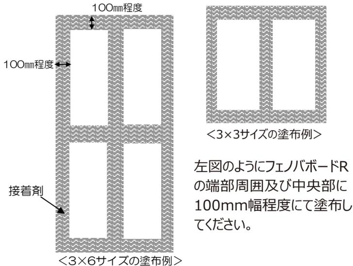
張り付け後、フェノバボードRに浮きがある場合はプラスチックピンで浮きを抑えてください。
