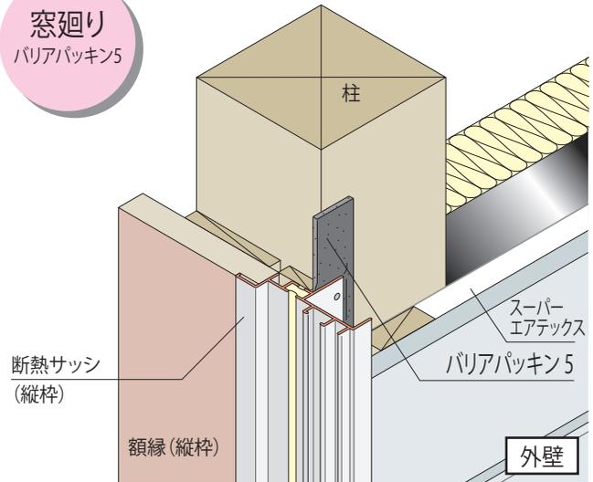
■施工納まり例(基礎断熱の場合)
