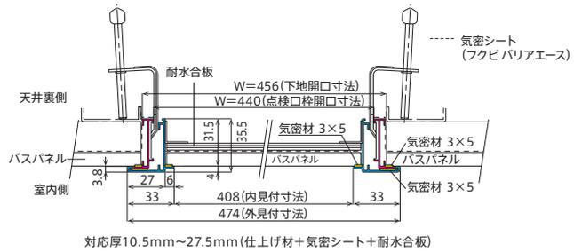
対応厚10.5mm~27.5mm(仕上げ材+気密シート+耐水合板)
