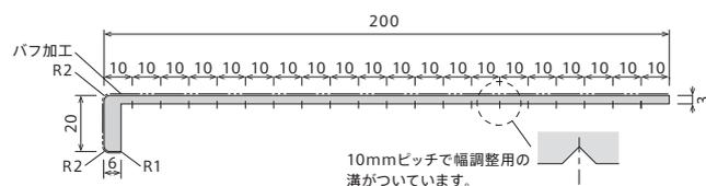
マルチユース窓枠カバー450 製品図
