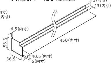
マルチユース窓枠カバー 参考納まり図
