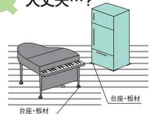
A フリーフローアーの積載重量は、建築基準法で定められた1㎡あたり180kgの基準を大きく上回る値で設計され、安全性を充分確保していますが、局部的な床の沈みが大きくならないよう、ピアノや冷蔵庫などの重量物を置く場合には、脚部の床の上に台座や板材などを置くなどして重量を分散させるようにしてください。現場での条件や必要性に応じてCP補強用支持脚の使用をお薦めします。
