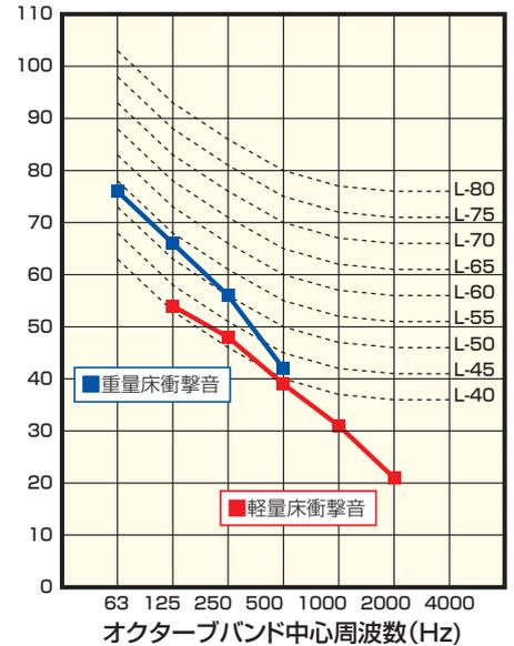
床衝撃音レベル推定値(計算値)は、旧(財)建材試験センターの算出法に準拠したもので、床衝撃音レベル低減量試験結果を基に、現場のコンクリート床板(厚さ150mm)に試料を施工した場合の床衝撃音レベルを推定したものである。
