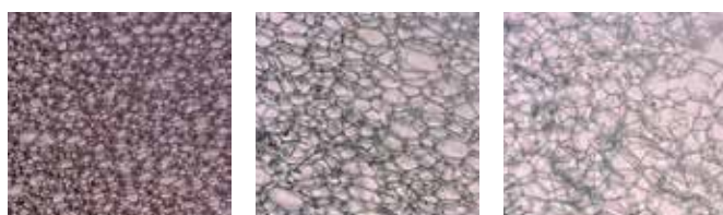
フェノボード 硬質ウレタンフォーム 押出法ポリスチレンフォーム
