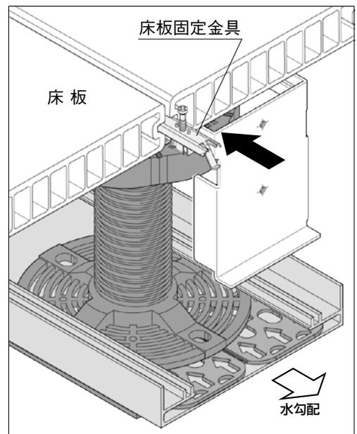
※入れにくい場合は樹脂支持脚部をカットし、金具支持脚部を上げ調整してください。
