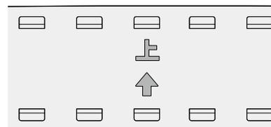
※裏面に「上↑」と刻印がされていますので、接着前に確認しながら取付け作業をすすめてください。
