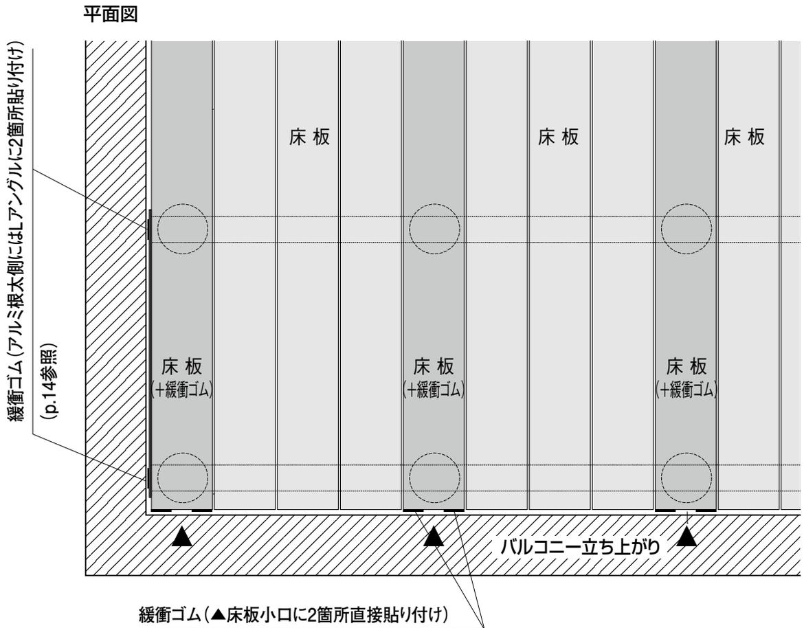
●床板の接着箇所の小口と剥離紙をはがした緩衝ゴム裏面の両面に接着剤(パンドー156A)を適量塗り、薄く均一に塗布し、指につかない程度まで乾かし、圧着して貼り付けてください。
