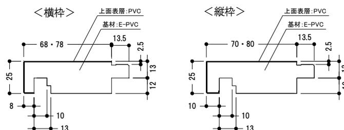
【参考納まり図】 ※図はGS-70(縦枠)、GS-68(横枠)の場合
