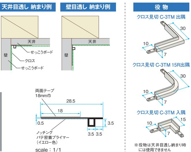
後付けタイプだから隙間の無い構造(省令準耐火構造)にも対応可能。
