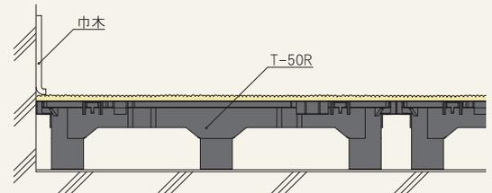
●壁際の納まり図(スベアスタンド使用の場合)
