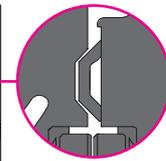
施工の際に、ツメがズレを防止しますので、簡単に施工でき、納まりがきれいに仕上がります。
