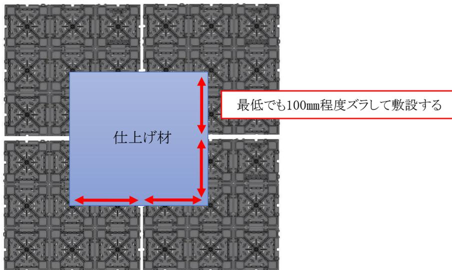
※注意 500mm角以外の仕上げ材を施工すると、割付によっては目地がOAフロアの目地と重なって、端部が浮いたり跳ねあがったりする可能性があります。ご使用を避けていただくか事前にご確認いただいた上でご使用ください。
