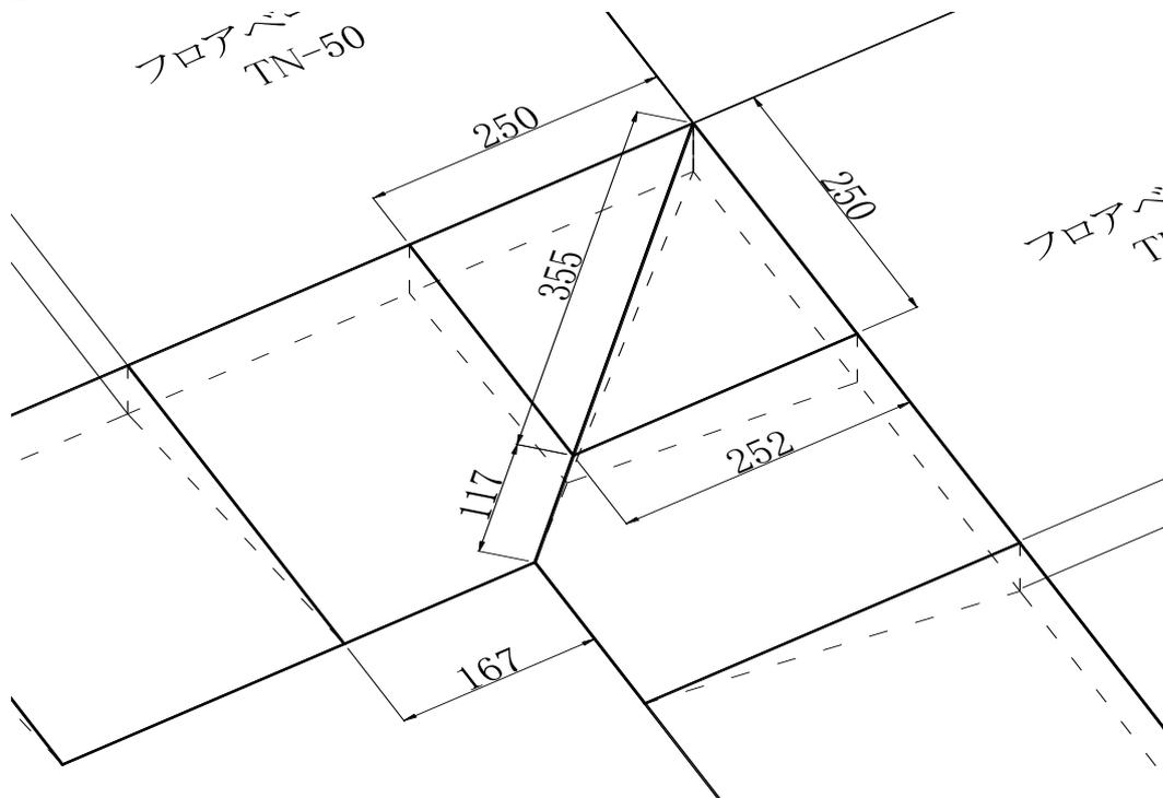
※注意 入隅部はスロープベース裏面の継ぎ目を両面粘着テープで貼り合わせ、コンクリートビスで固定してください。
