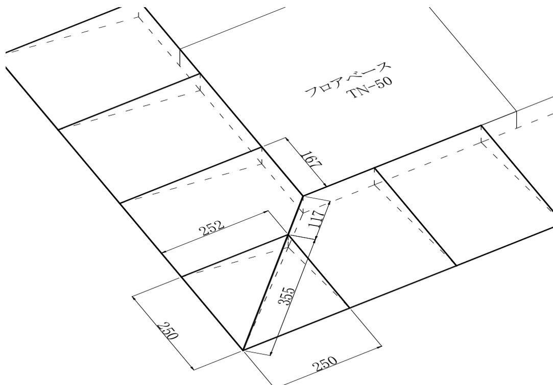
※注意 出隅部はスロープベース裏面の継ぎ目を両面粘着テープで貼り合わせ、コンクリートビスで固定してください。
