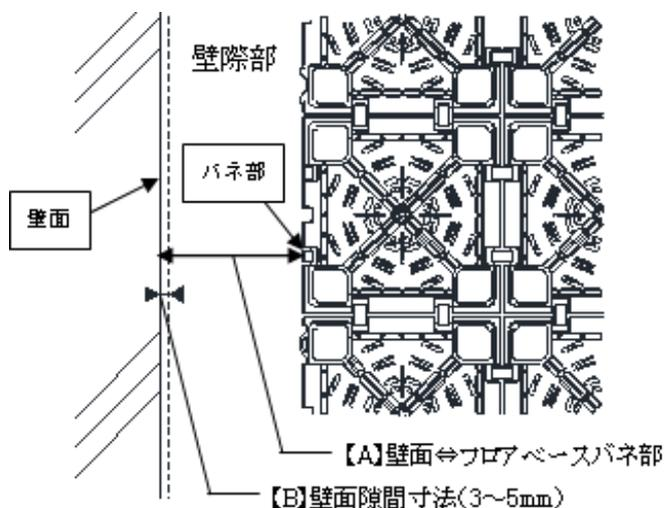
切断加工を行ったフロアベース裏面のリブに、補強としてスペアスタンド50Sを差し込み(フロアベース長さ500mmに対し9個取り付け)、フロアベースの敷設を行う。
