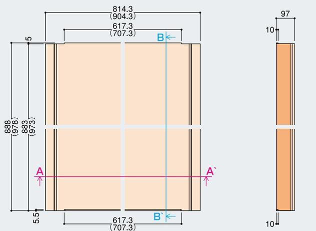
■フクフォームN製品図 S=1/20(A-A断面図 S=1/10)
