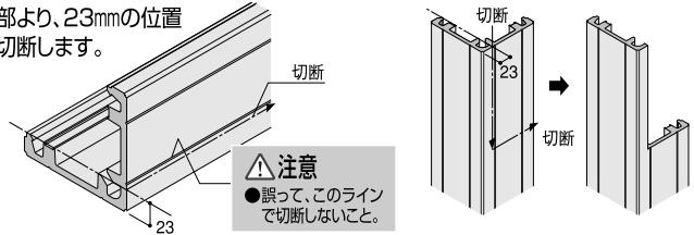
②切断した部分に455mmピッチ以下でビス止めします。また、端部は、15mmの位置にビス止めください。また、切断した部分の壁面への取付けには、追加ビス打ち部にも必ずビスを打ってください。
