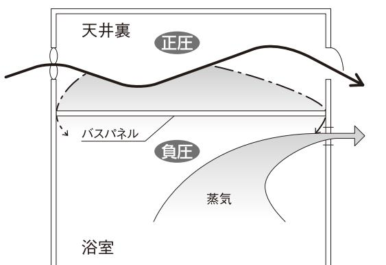
●天井裏換気に第2種機械換気を設置して、天井裏が正圧、浴室が負圧になるようにし、湿気を含んだ空気が天井裏に侵入しないようにしてください。
