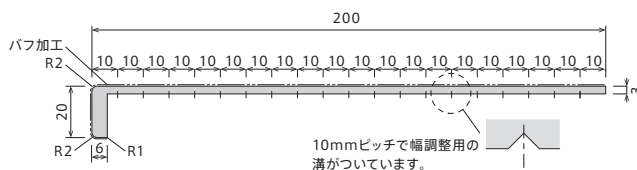
マルチユース窓枠カバー 製品図
