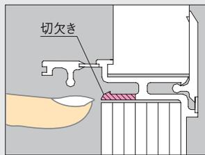
点検口枠4辺のうち1辺に切欠き(巾12mm・深さ4.5mm)がしてありますので、それを利用して内蓋を取出してください。
