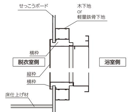
※接着材またはビス、もしくは接着材・ビスの併用にて取付けください。
