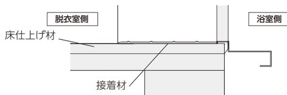
※接着材またはビス、もしくは接着材・ビスの併用にて取付けください。
