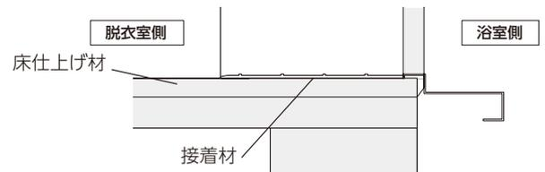
※接着材またはビス、もしくは接着材・ビスの併用にて取付けください。
