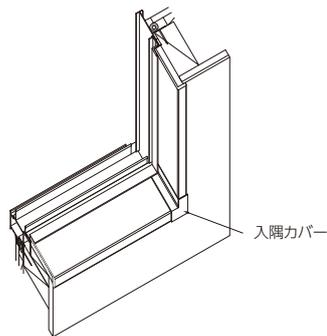
■横枠(上枠)、横枠(下枠) 縦断面納まり
