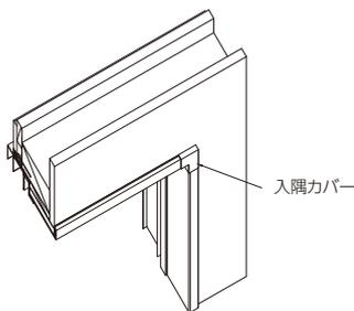
■縦枠－横枠(下枠) 納まり
