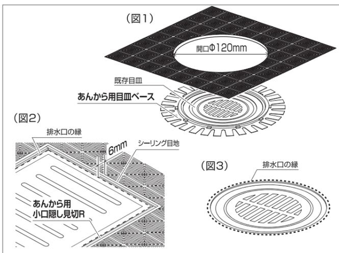
⚠注意 ●既存の排水口に設置してある目皿のサイズがφ100mm未満であることを事前に確認してください。100mm以上ある場合には既存の排水口の目皿が取り外せなくなります。
